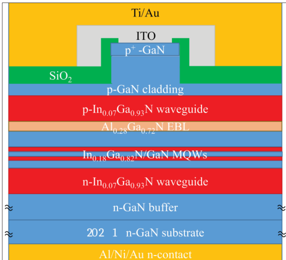
图1. 制作的具有ITO p-型接触层的激光二极管的横截面示意图。
