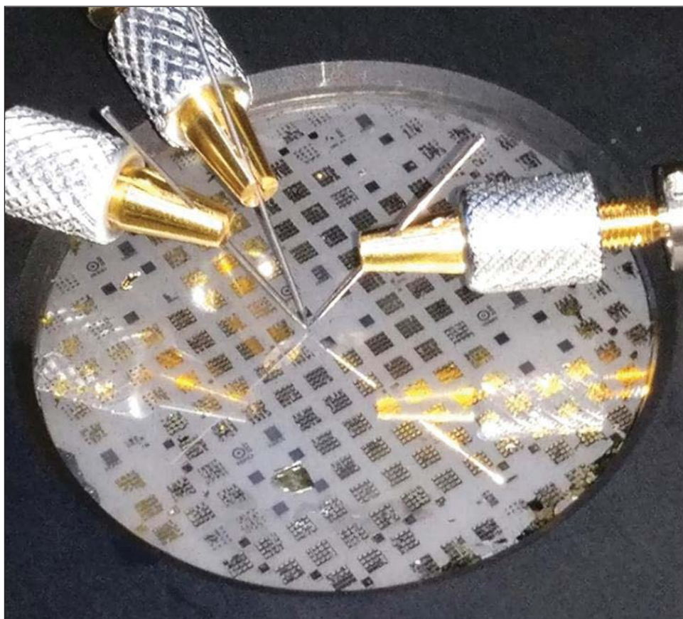
图1：正在测试的晶圆级的AlGaN/GaN传感器。（来源：洛林佐治亚理工学院）。
