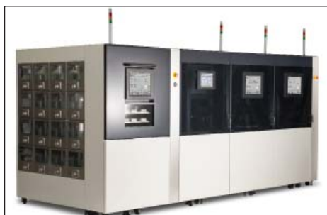
图2: 日本SEMICON上展出的KABRA!zen系统 (使用最少量的设备配置来执行KABRA工艺)
