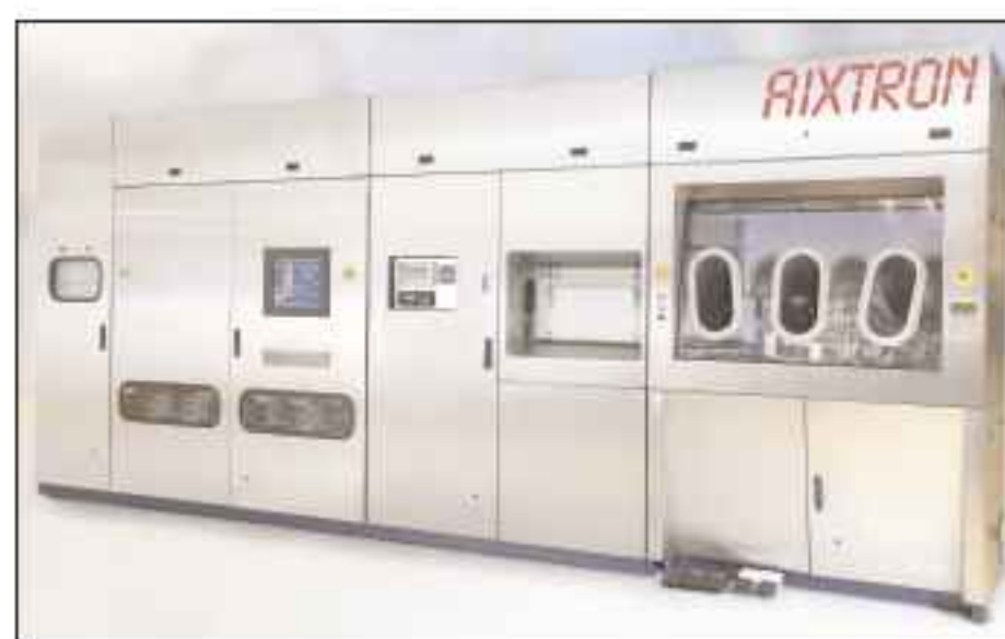
Aixtron's high-volume AIX 2800G4 MOCVD system.
