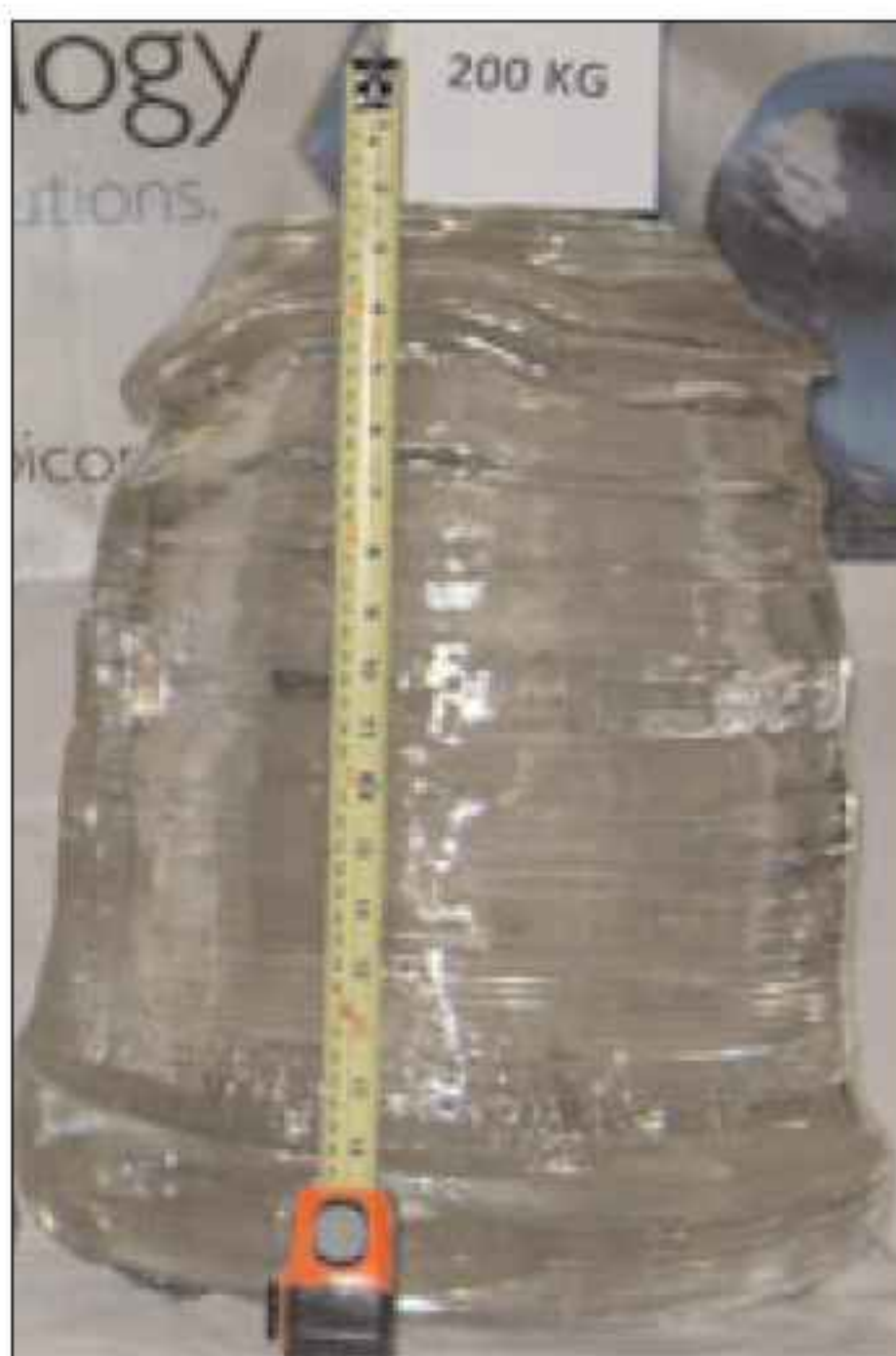
Rubicon’s 200kg sapphire boule.
